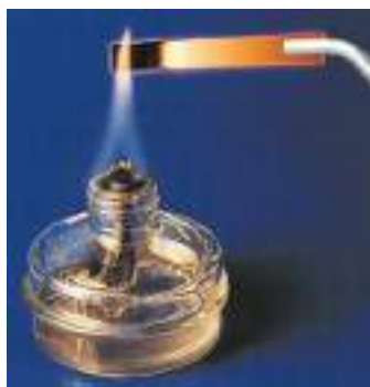
Fig. 2.3. La încălzirea în aer liber, cuprul interacționează cu oxigenul și formează oxidul de cupru (II) (de culoare neagră).
