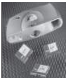
Aparat digital de fotografiat Imaginea numerică se înmagazinează în cartela de memorie
