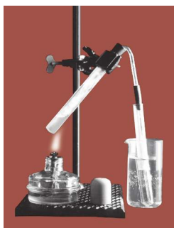
Fig. 3.6. Distilarea apei într-o instalație simplă
