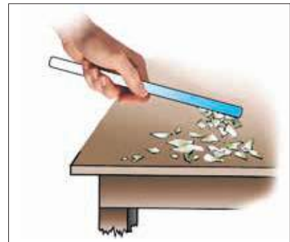
4.1. Tubul de plastic frecat cu țesătura atrage bucățelele de hârtie
