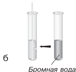
Рис. 5.6. Получение ацетилена в лаборатории и обесцвечивание раствора KMnO_4 (а) и бромной воды (б)
