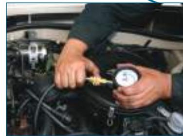
Рис. 12.7. Проверка компрессии в цилиндрах
