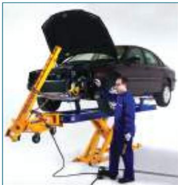
Рис. 12.6. Автоподъемник
