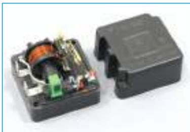
**Рис. 11.16.** Пускозащитное реле холодильника
