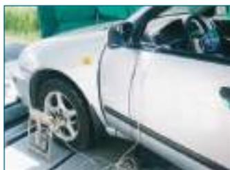
**Рис. 12.11.** Проверка люфта рулевого колеса
